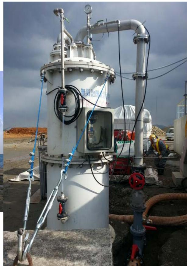
**YE-900FC型 給水・吐出径:100A 通水量:2100ℓ/min**
