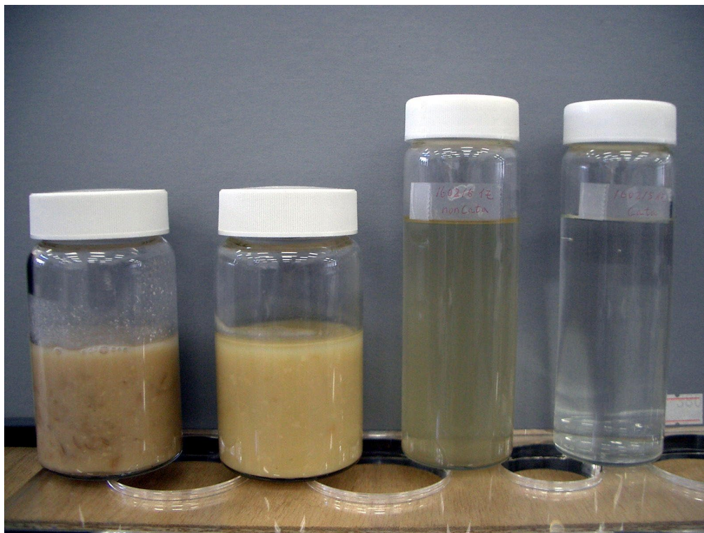
写真 9; 処理前、処理途中、処理後の芋焼酎廃液
