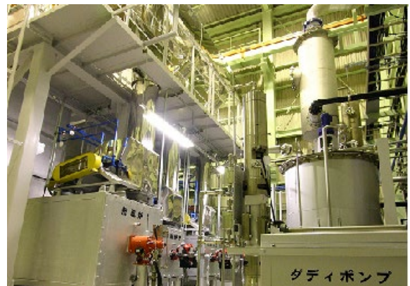
写真 6 : 焼酎廃液処理用装置(20t/day)
