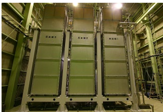
写真 7 ; 焼酎廃液処理装置の反応塔部 (20t/day)
